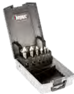
ESTUCHE AVELLANADORES HSS DIN335C HEPYC Punta de 90° Ø6,3-8,3-10,4-12,4-16,5-20,5.
